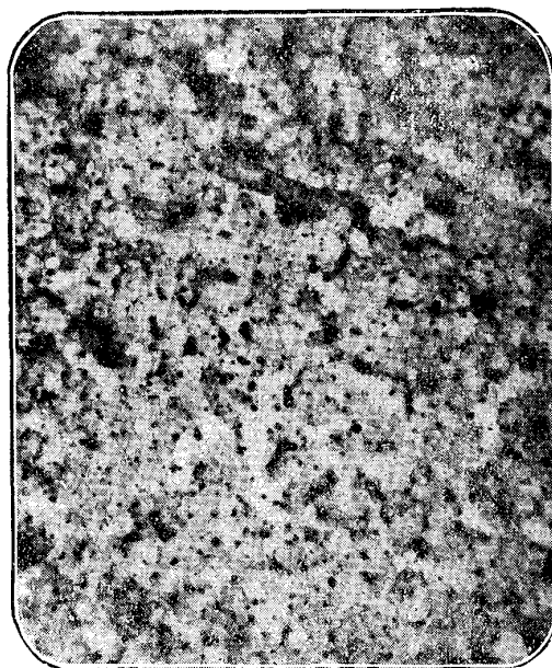
第六圖 離心鑄造に依る特殊青銅軸承鑄塊の断面（腐蝕し六十倍に擴大せるもの）結晶粒は特別に小なるを知る
