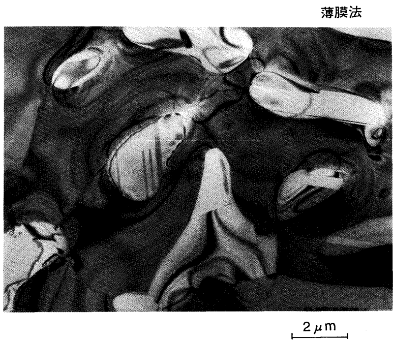
写真3 22Cr-6Ni中のσ相 (暗い部分) の観察例とσ相, 母材 (γ) のEDXによる分析例 (写真において, σ相は暗い部分で, 明るい部分はγ相である)
