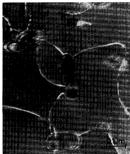
写真1 Al-2.8at%Mg-6.3vol%Al 6 Mn合金を573K、57.3MPaでクリープ変形後、弱ビーム法によって観察した転位と粒子との引力型相互作用
