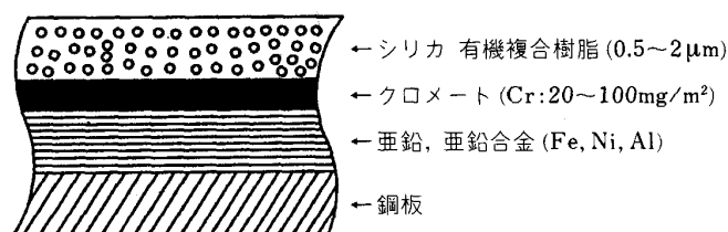
図1 シリカ有機複合被覆鋼板の皮膜構成
