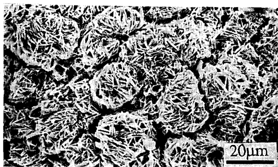
写真 12 BSCCO 系アモルファス状態のファイバーの熱処理後の断面組織 55)
