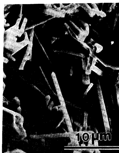
写真 7 写真 6 の組織を有する試料を 211 相 + 液相共存温度領域へ再加熱急冷した試料の組織 45)
