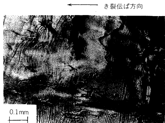
写真 7 プラスチックス (PMMA) 疲労破面のストライエーション 10)
