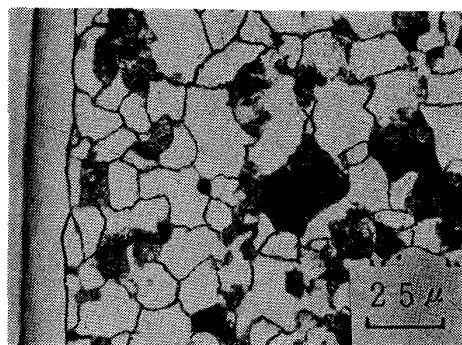
写真2 炭素鋼の軟窒化組織 (570°C × 60 min 処理後水冷)
