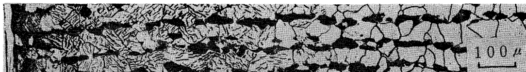
写真3 炭素鋼を 570°C × 60 min 処理後水冷した試料を 300°C 焼もどし
