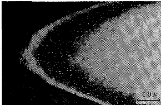
写真 4 高速度鋼タップのイオン窒化 (C 0.38%, Cr 1.10%, Mo 1.50%, V 1.00%)
