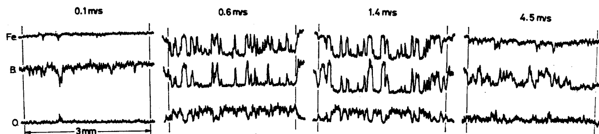
Wear depth, 0.1m/s : 9\mu , 0.6m/s : 14\mu , 1.4m/s : 28\mu , 4.5m/s : 15\mu
