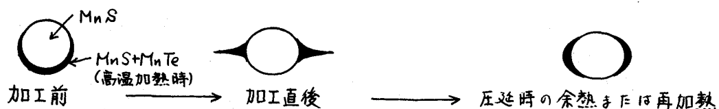
図1. S, Te複合介在物の球状化機構(模式図)
