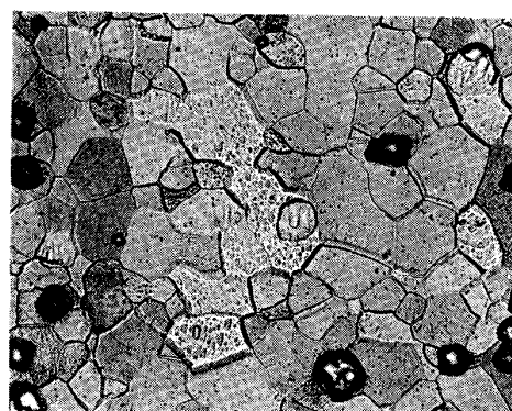
図1. Primary-Goss粒の合体進行状況(Z面)×300
