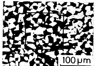
図1 光学顕微鏡組織例 ( f=0.51 , 枠内を450要素に分割、モデル化LK)
