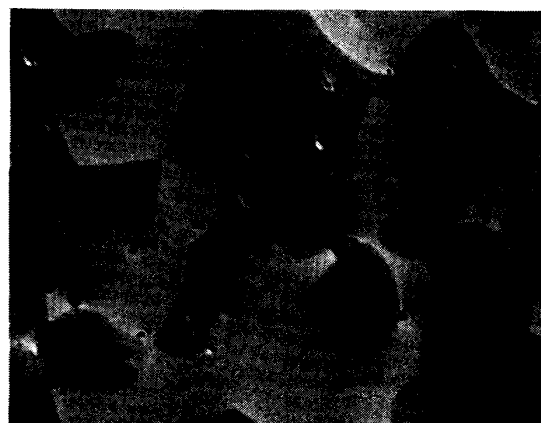
写真1 1100℃, Ni-50Cr-10W合金の反射電子組成像
