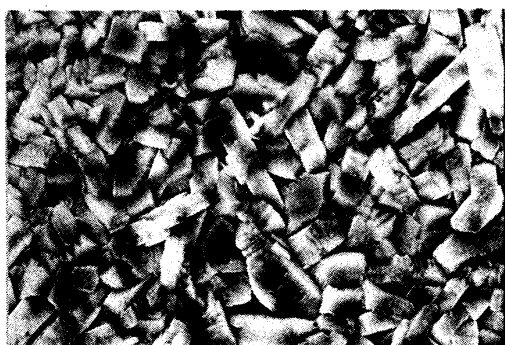
写真1. リン酸塩処理後の非メッキ面
