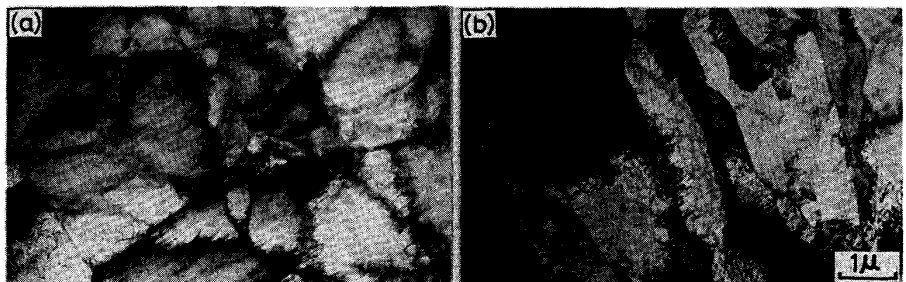
写真1. 二相域圧延材の薄膜電顕組織、 \omega Si-Mn 鋼, 685°C 仕上 (b) Nb-V 鋼, 675°C 仕上
