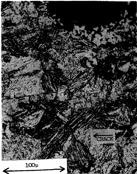
写真1: 曲げモーメントによるノッチ下での引張り応力(113 kg/mm 2 )を負荷して後9分程度して発生した遅れ割れ(100 \mu 程度の長さ)、高温添加による初期水素量: 5ppm
