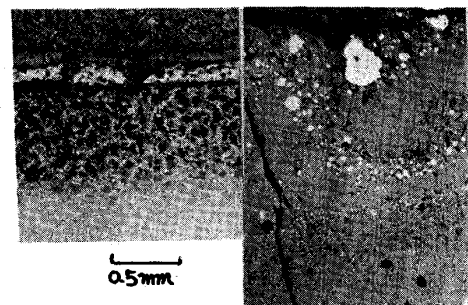
写真1 反応後の断面顕微鏡組織 (a) 1200^\circ\text{C} \times 10 \text{ Hr.} (b) 1400^\circ\text{C} \times 10 \text{ Hr.}
