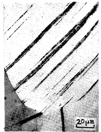
図10 Fe-19Ni-0.03C ( M_s = -45^\circ\text{C} ) を100℃で30%ひずりした時の光学組織
