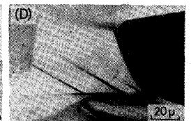
図11 A 18℃, B 50℃, C 100℃, D 200℃で約30%引張変形した時の組織 (図10, 11はFe-24Ni-0.47C合金)
