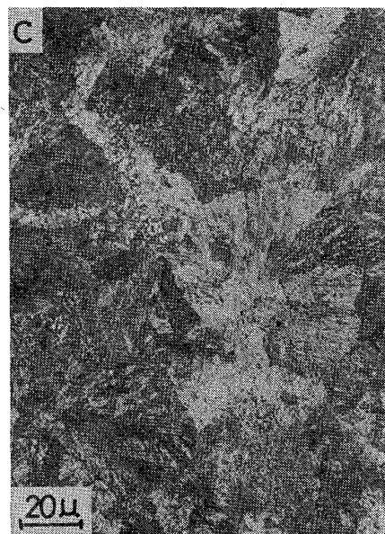
c 端頭部熱処理レール H_B 332 (微細パーライト)
