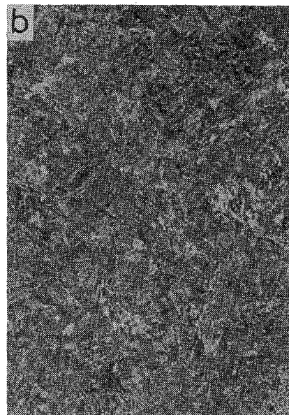
b 熱処理硬頭レール H_B 340 (焼もどしマルテンサイト)
