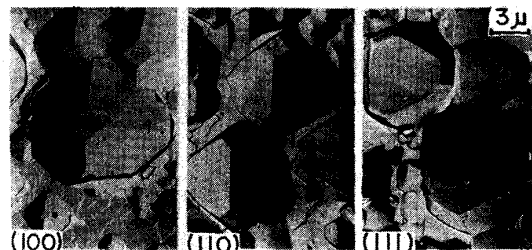
写真1 オーステナイト系ステンレス鋼の低指数面に現出したファセットピット（電顕レプリカ）。
