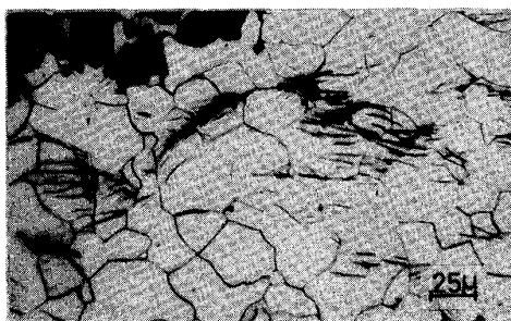
写真1. 鍛鋼でのすべり帯を起点とするき裂 \sigma = 20 \text{ kg/mm}^2
