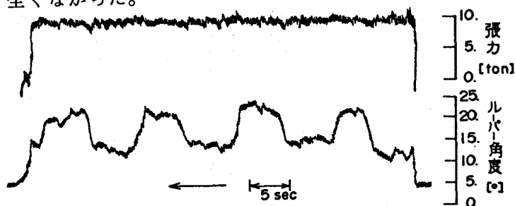
図6. 張力制御性の実機テスト(外乱付加)結果
