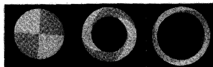
写真2. PPM, CRP方式におけるメタルフローの違い
