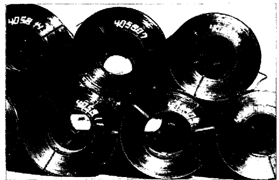
写真 4・7・1 自動マーキング装置でマーキングされたホットコイル
