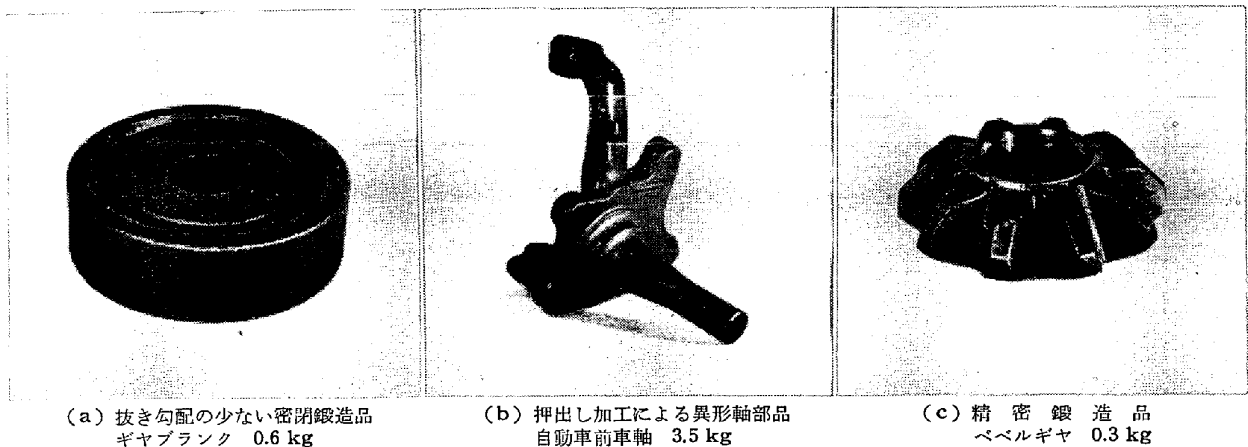
写真 4-6-2 熱間鍛造品の変遷を示す例
