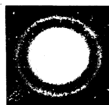
写真4 電子線回折による析出物の同定 (BN)
