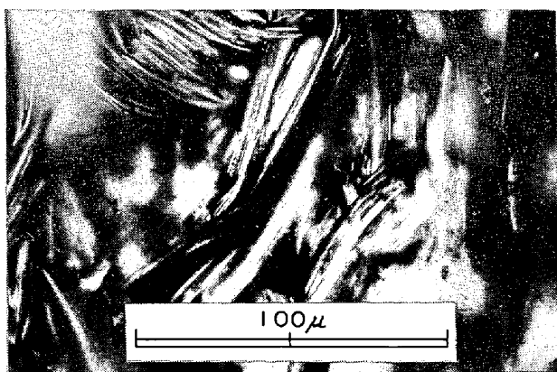
写真 5 Fe/Al=1/2 の合金の硫化腐食後の表面組織。 ( p_{S_2}=1\text{atm} ; 900°C, 5hr 腐食)
