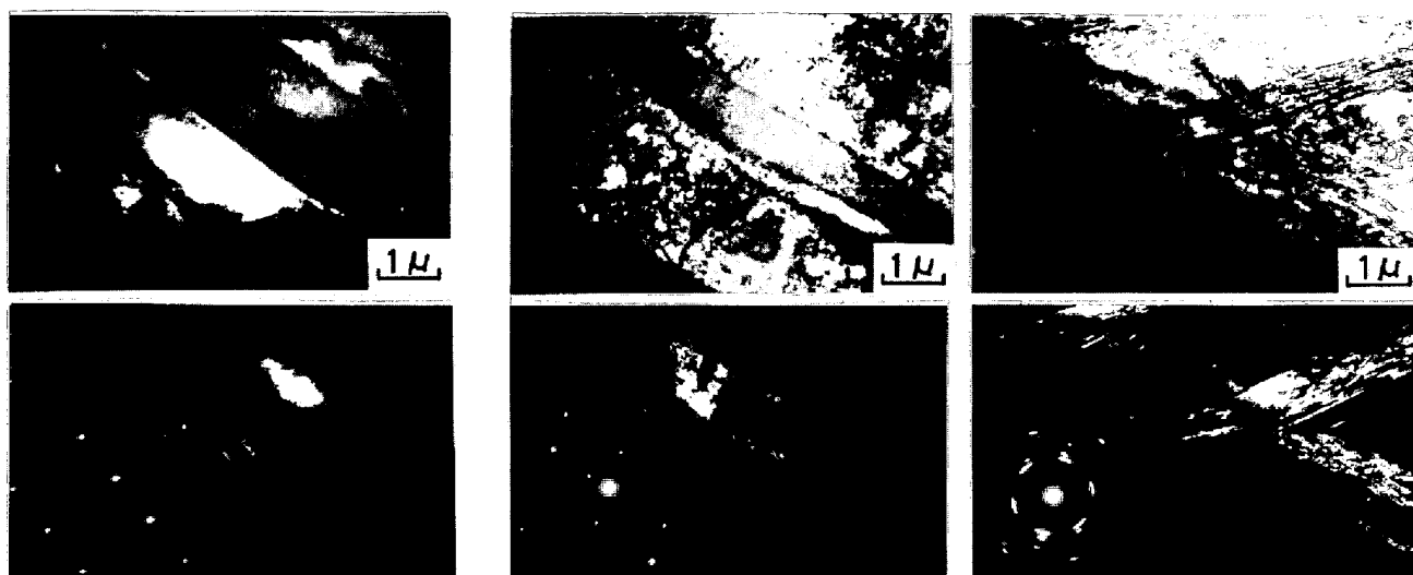
a) athermal なマルテンサイト ( -125^{\circ}\text{C} ) b) 変形により生成したマルテンサイト ( -50^{\circ}\text{C} ) c) 150^{\circ}\text{C} で破断した組織中のマルテンサイト
