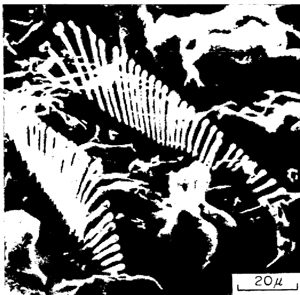
写真3 deep etch により現出した鑄造ままのⅡ型 MnS 20)
