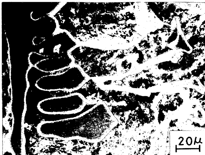
写真1 走査電子顕微鏡像 (V: 7.0 °C/min)
