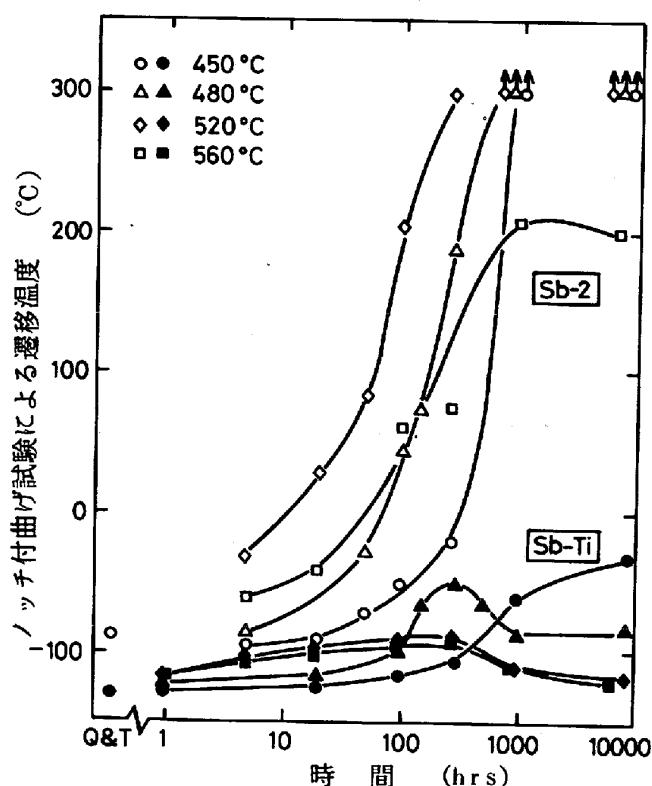
Sbを添加した極低C-3.5%Ni-1.7%Cr鋼の等温焼もどし脆化曲線 (1200°C×1hr W.Q+625°C×1hr+450~560°C等温保持)
