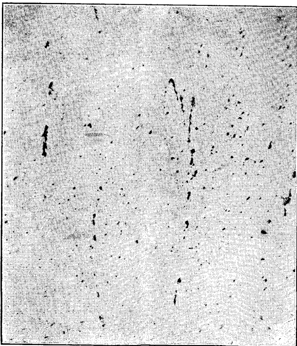
第十九圖 ニッケル鋼中の鐵滓（百倍大）
