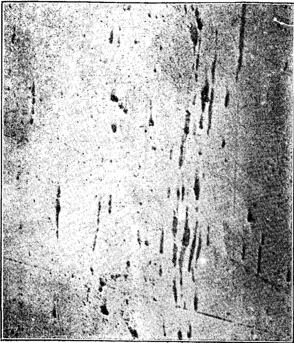
第十八圖 タングステン鋼中の鐵滓（縦断面百二十五倍大）
