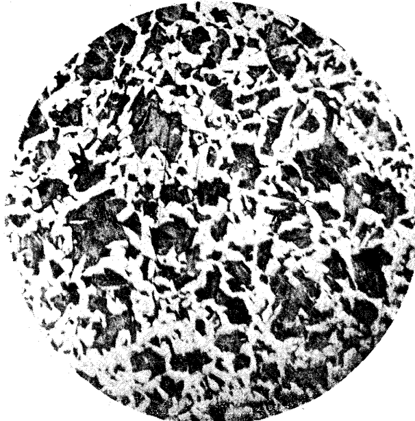
鍛縮度 \frac{1}{8} 鍛鍊ノ儘ノ斷面 70倍
