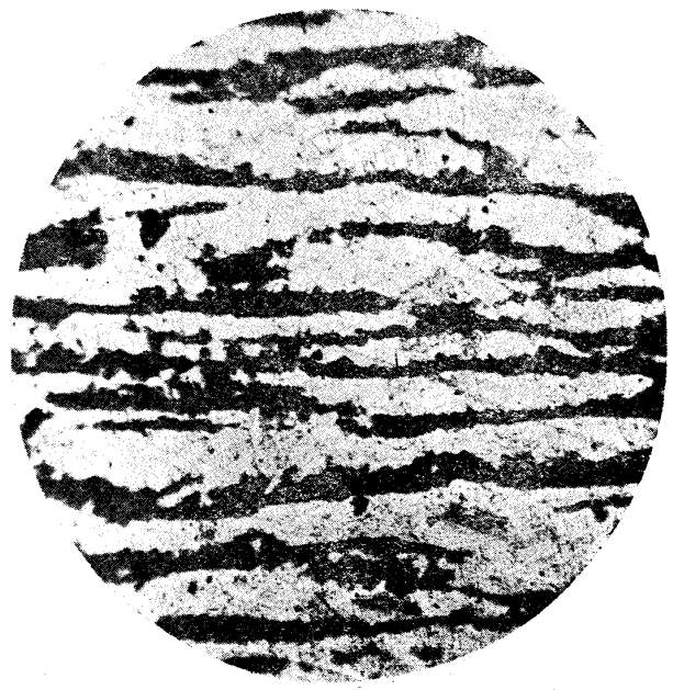
丁材 (イ) 焼鈍セル捻扭部 平行面 80倍
