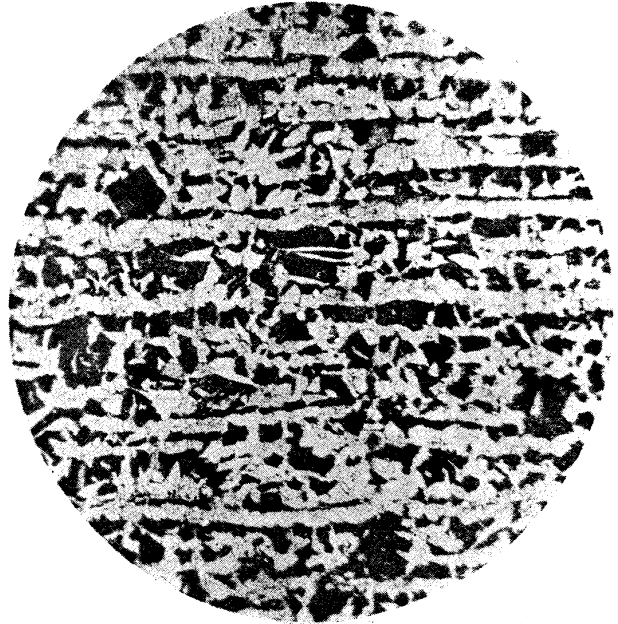
丁材 (イ) 焼鈍セサル捻扭部 平行面 80倍
