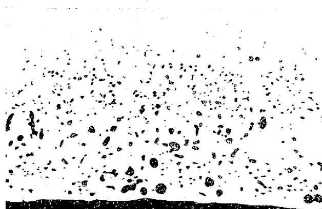
写真6 Fe 6.0%Mn, FeO-SiO 2 -Al 2 O 3 36.7 44.1 19.2 1300°C, 10hr 均熱 (×100)
