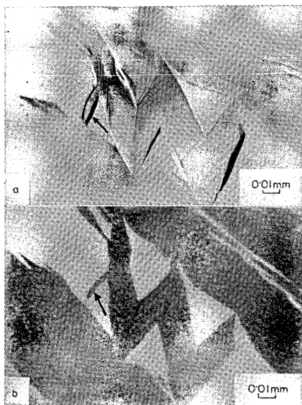
写真3 Fe-32.5%合金の加熱逆変態の初期
