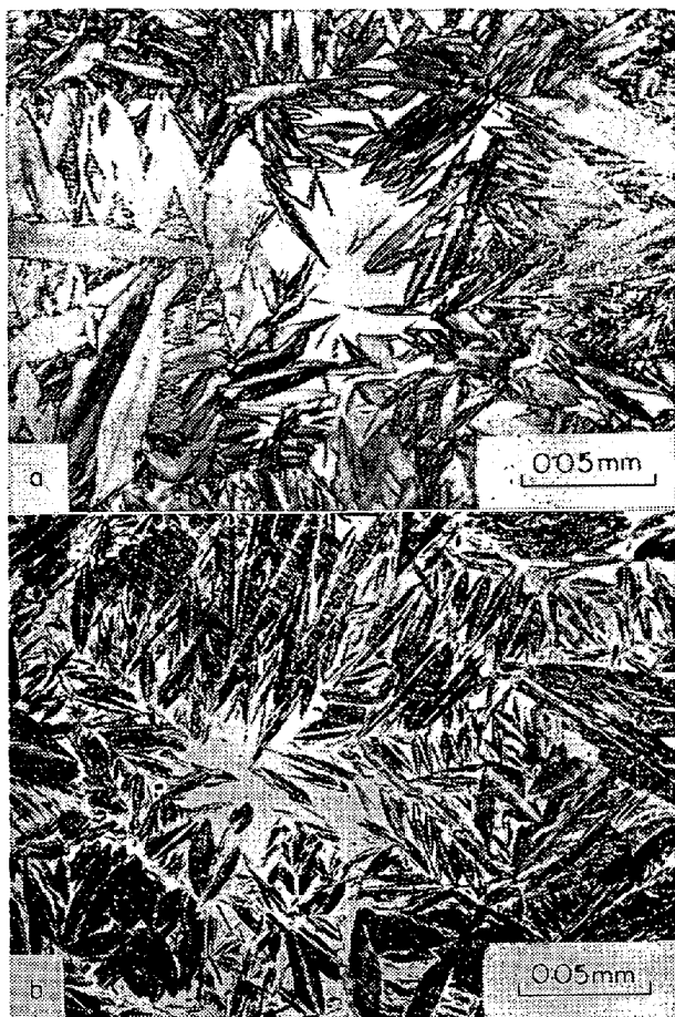
写真7 Fe-32%Ni 合金における bcc ( \alpha' ) および fcc ( \gamma' ) マルテンサイト
