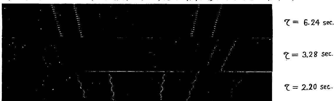
写真1 水銀の振動減衰挙動記録例
