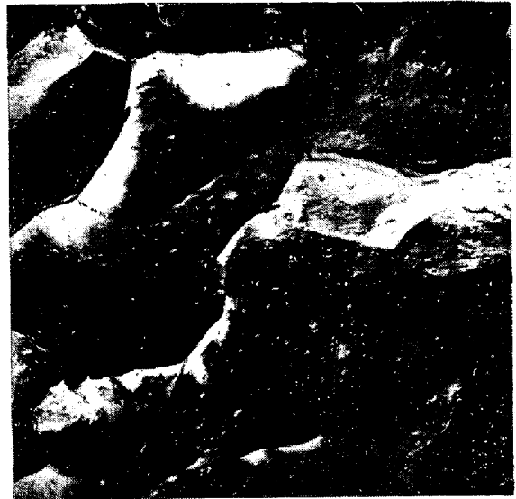
写真23 Al合金(7075-T6)の応力腐食割れ破面。
