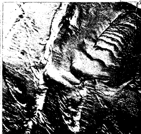
写真19 Tire truck あるいは caterpillar pattern と称される形態 (2017-T6, 回転曲げ). ×3000 (3/4)
