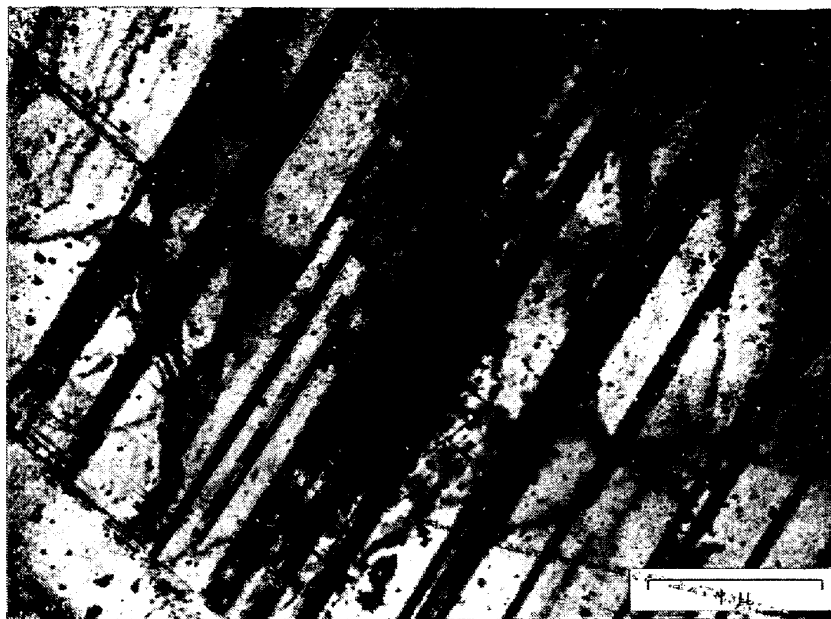
写真6 9.75%Mn 0.97% C鋼を焼入後鍛打したもの。 (黒いバンドに見える板状晶は \epsilon_M ) (西山, 清水) 10)
