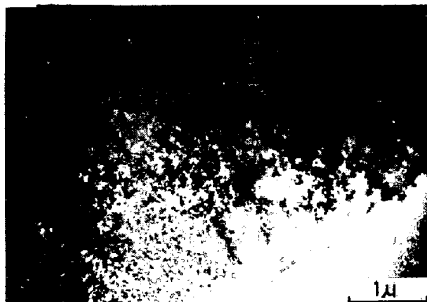
写真1 0.53C-17.45Mn-11.73Cr-1.93Ni-2.11V 鋼の800°C, 5minに等時時効後の 透過電子顕微鏡写真
