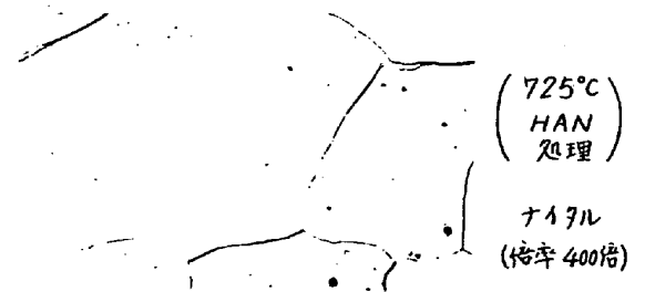
写真1 リムド鋼の725°C熱間引張り加工におけるフェライト組織
