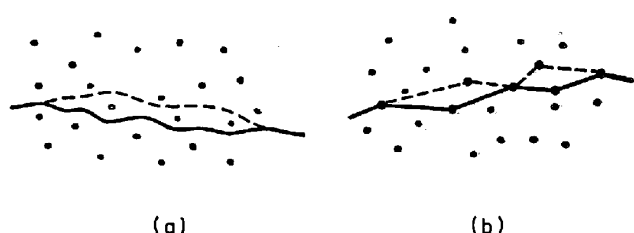
図20 転位と固溶原子との相互作用，(a)は長距離の周期的な内部応力場中の転位の運動(b)は転位芯と固溶原子が強く相互作用する場合の運動を示す。
