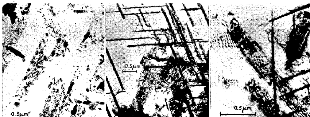
写真8 積層欠陥上に析出したV炭化物 a・b・c の順に時効時間が長くなる 72)
