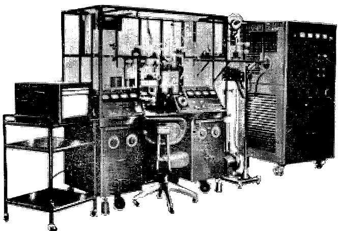
本装置は金属中の全酸素、全水素、全窒素、を同時に定量する装置であり、試料としてはガス抽出温度などの条件を適当に採ることにより、鋼、タンタルチタン、ウラン、モリブデン、ジルコニウム、クローム、銅、その他の新金属の分析も可能であります。
