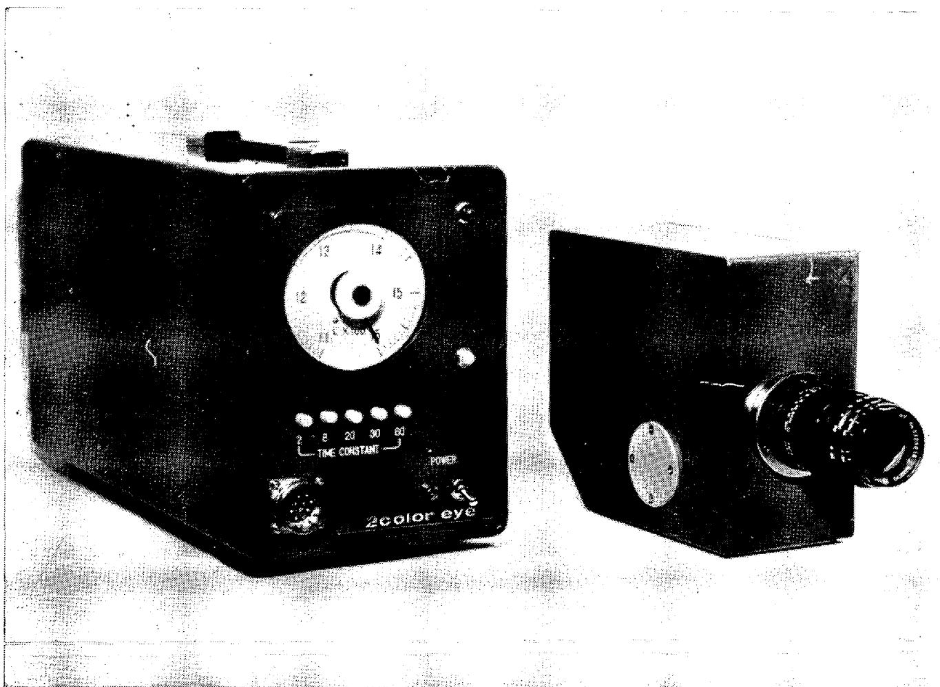
非接触で、しかも熱電対と同等の精度が得られる温度計の出現が長く待ち望まれておりました。ツーカラー・アイはこの要望に応えて、我国で初めて実用化された自動2色式温度計であります。
