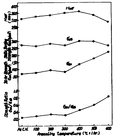
図1 冷間加工した鋼の遅れ破壊特性に及ぼす焼なましの影響。
