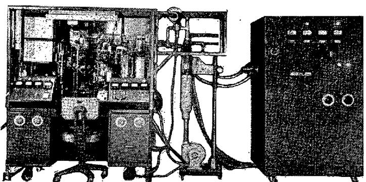
本装置は抽出炉を Glundner & Beach 型の変型を用い、ガス分析は定容測圧式を採用して居ります。主要部分の抽出、捕集、排気のポンプは高性能のテレックス硝子の水銀ポンプを用い、必要水銀量も約 7kg の少量であり、各部品の簡易化と共に操作も容易である等の数々の特長を有して居ります。
