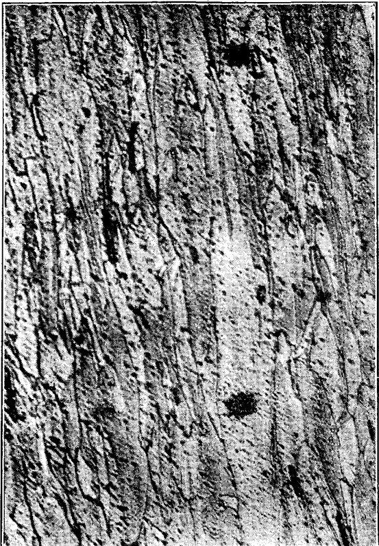
3. 鍛鍊係數 33 % の壓延方向面(素板厚 20 m/m)
