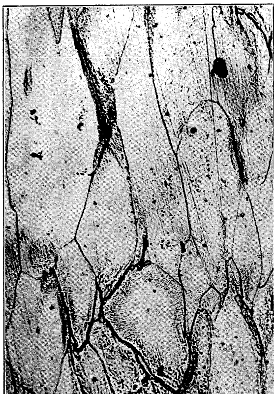
1. 鍛錬係数 50 % のものを四百五十度にて二時間分間軟過(厚 10 m/m の素板を 5 m/m に壓延)
