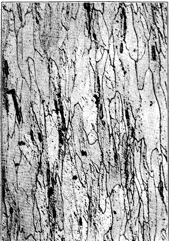
6. 厚 8 m/m の壓延鋼(700 度過)を 4 m/m に壓延せしものゝ鋼厚の中心部但素鋼厚 16 m/m
