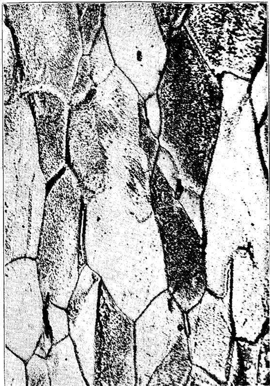
3. 厚 22 m/m の素紙を 9 m/m に壓延し 900 度に軟過して 4.6 m/m に壓延したるもの
