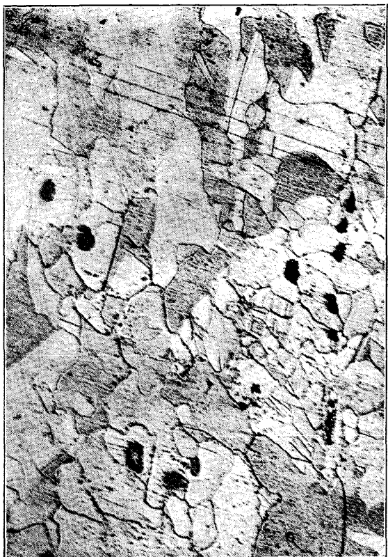
7. 素紙厚 21.0 m/m を 9.0 m/m に壓延し七百度にて軟過し 6.75 m/m 耗に壓延せし壓延面
