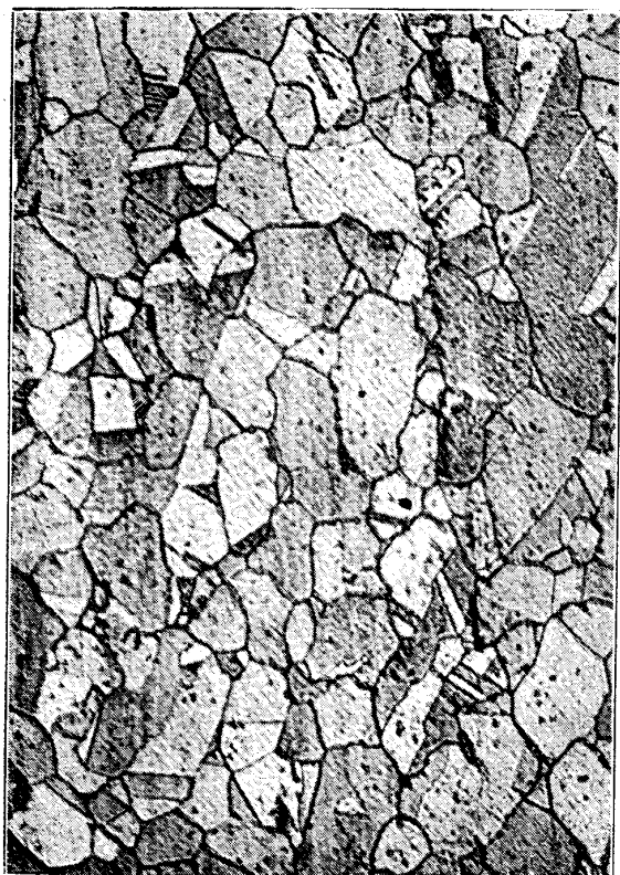
5. 鍛錬係数 33% の壓延方向面を 700 度軟過 (素板厚 20 m/m)
