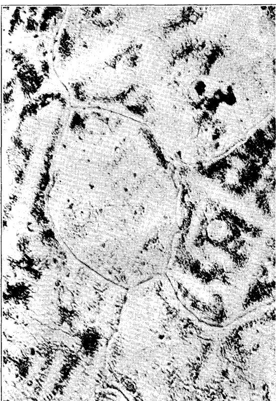
5. 冷型鑄造素鉄厚 20 m/m を 15 m/m に壓延したる壓延面下 0.3 m/m の處 鉄面に法線方向より見たるもの. 二百倍大
