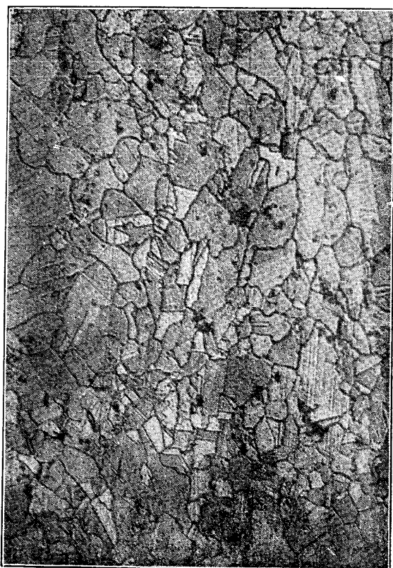
2. 鍛錬係数 50 % のものを七百度にて軟過せしもの(但し新地金のみの配合にて鑄造を十回繰り返せしもの)
