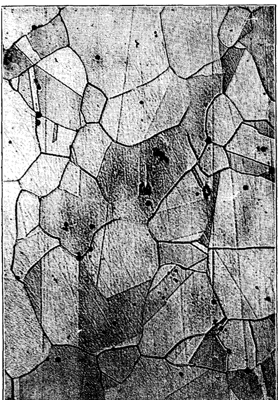
附圖十八 白銅の顯微鏡的性質に及ぼす軟過溫度及時間の影響 (各五百倍大)
