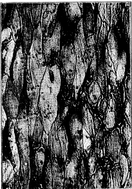
1. 1400 度軟過後 18 度の水中にて急冷 (軟過前の鍛錬係数 50% 以下同じ)
