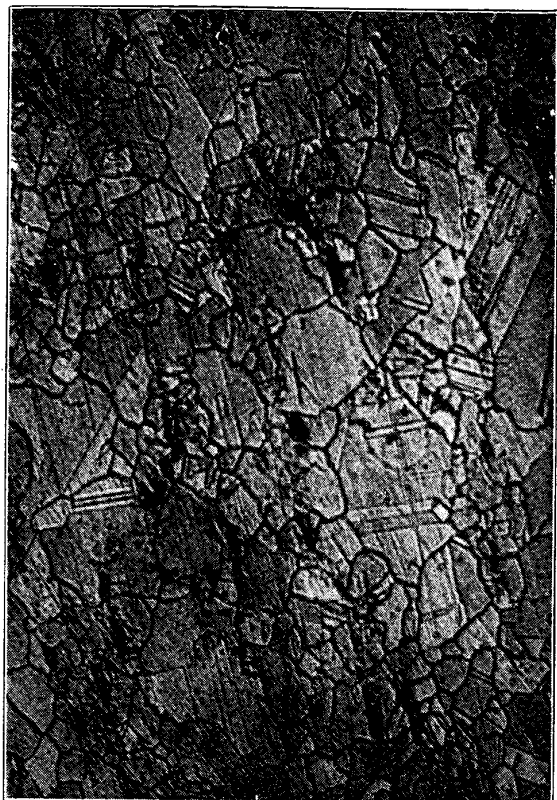
3. 鍛錬係数 50 % のものを七百度にて軟過せしもの (但し殘彈潰屑のみにて鑄造を十回繰り返せしもの)
