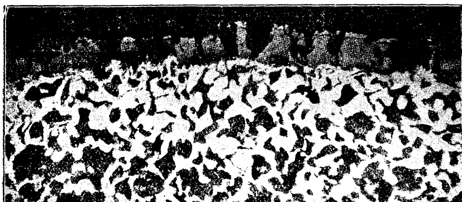
加熱延せたる小なる棒の鋼の端部の横断面をピクリン酸にてエツセ (のるも) (擴大二百倍)
