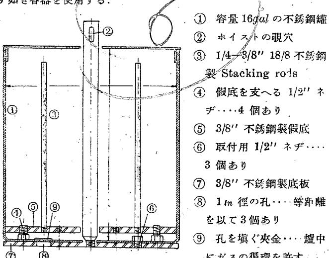
16番の 26/20 Cr-Ni 合金製の罐が  $3/8\text{ in}$  の板の上に乗つてゐる、その板と罐は 3つの互に合致する孔を有しこの孔の上に蓋がある。品物は内部の上げ板(假底)の上に乗る。その上げ板には圓の如く細い柱が立つ雌ネヂ孔が所々にある。罐の蓋は弛くかぶさつて爐の雰囲氣が徐々に循環するやうになつてゐる。この容器を油に浸すと油は底板の孔から蓋を押し上げて中に入る。罐中のガスは收縮し低壓になる。油は直ちに罐を充す、この容器は品物の表面を綺麗に保つと云ふ點に特長があつて焼入したものとせぬものとが硬度を測定しなければ見別けがつかぬ程である。
