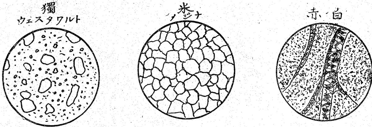
此の化學成分では一寸良否の區別が出来ないが顯微鏡で組織を見ますと、圖の如くで獨逸のものは大、小の稍圓味を帯びた石英粒が微晶質石英の中に散らばつて居る、ザクセンの硅岩はこれと同組織であるがへツセーの硅岩は米國のメジナ硅岩と全く同じである、へツセーの硅石は獨逸では二等品として取扱はれて居る。
