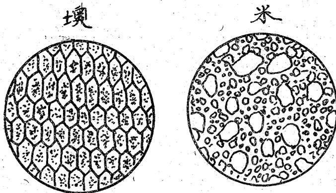
塊のものはペリクレスの結晶が非常によく發達し結晶と結晶の間には珪酸物が少なく粒の中にマグネシヤフェライトの微粒を認める、これに反し米のものは結晶の發達充分ならず粒間には珪酸化合物の可なり多く認めるのである。大石橋のものは米式に近くあるが原鑛より珪酸
